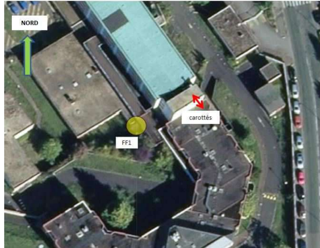
Figure 25 - Plan général de l'implantation des sondages ( Althea, 2018 )
